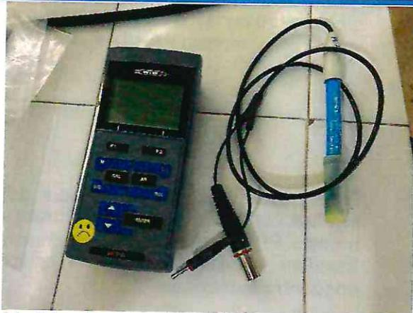
Medidor de pH portátil WTW modelo pH3210.
